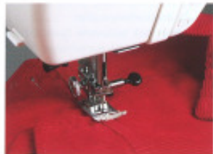
Oberlauf mit zusätzlichem Raum für dicke Stoffe
